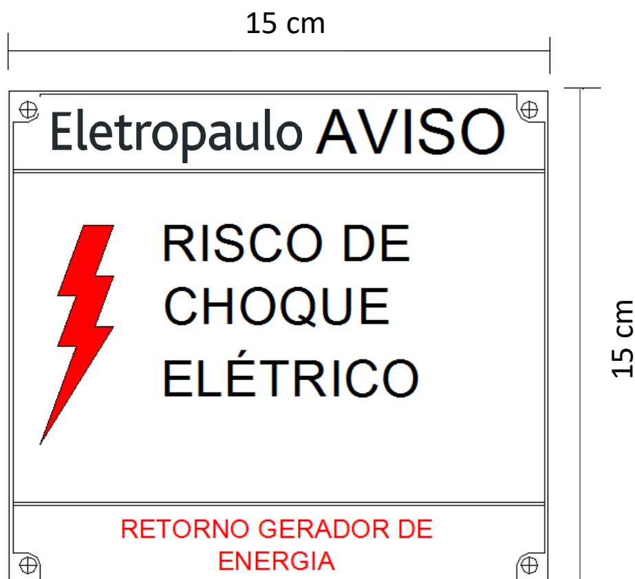
Figura 10 – Placa de sinalização padrão de conexão de micro e minigeração
